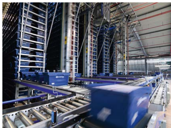
Für die Lagerung zahlreicher Artikel hat Bauerfeind ein automatisches Kleinteilelager aufgebaut, in dem die Produkte in Mehrwegboxen gut geschützt aufbewahrt und befördert werden können.
