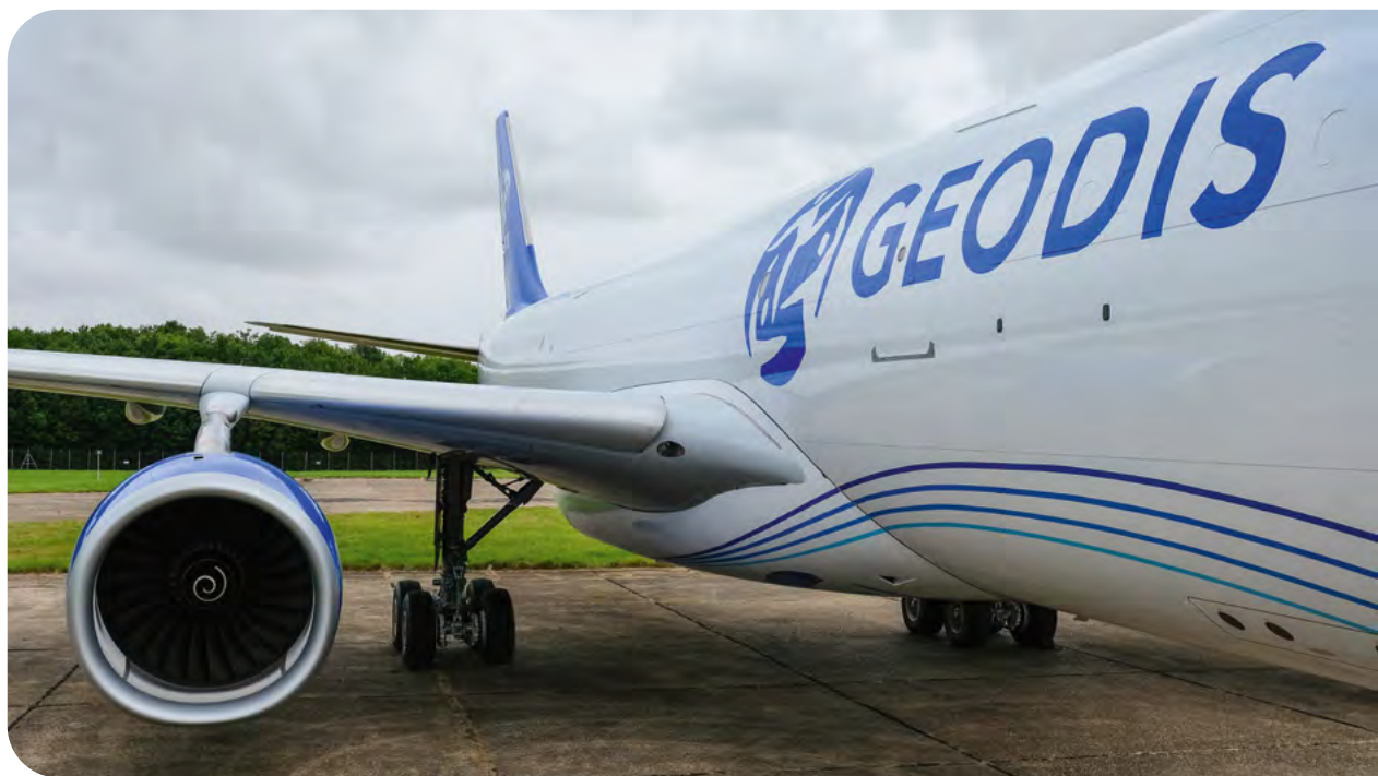
Neben gebuchten Kapazitäten bei Airlines nutzt GEODIS für sein Luftfracht-Angebot auch eigenes Fluggerät: Der Fracht-Airbus A330-300 kann beispielsweise 62 Tonnen Ware mit einem Volumen von 480 Kubikmetern befördern.
