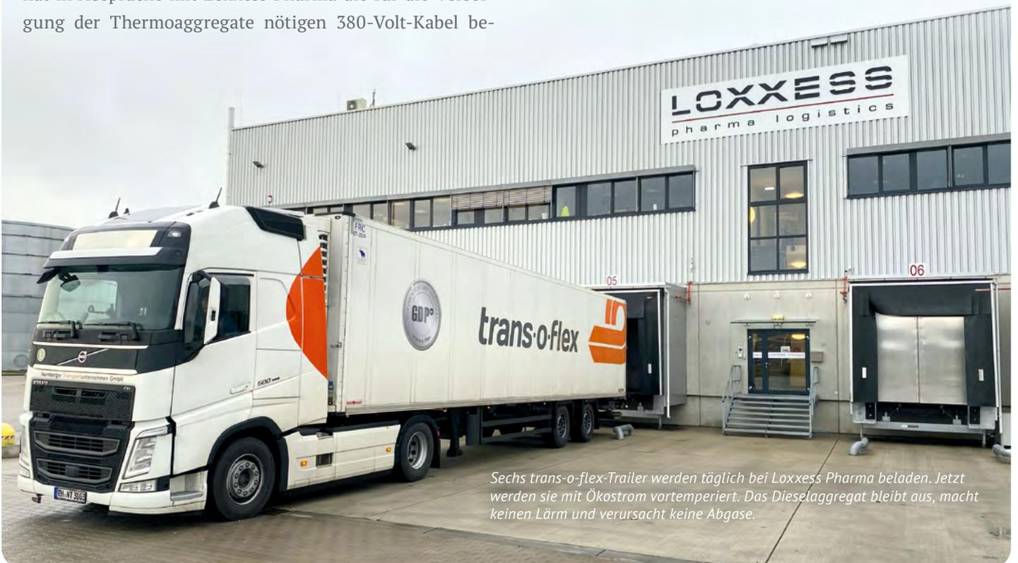
Sechs trans-o-flex-Trailer werden täglich bei Loxxess Pharma beladen. Jetzt werden sie mit Ökostrom vortemperiert. Das Dieselaggregat bleibt aus, macht keinen Lärm und verursacht keine Abgase.
